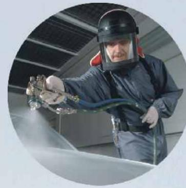
萨塔手动喷枪的压缩空气接口均为1/4英寸 外螺纹
