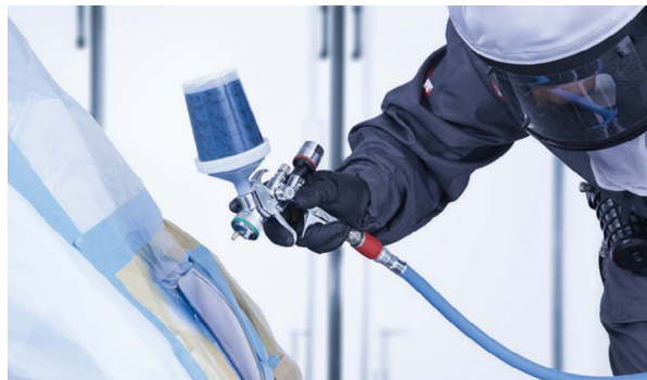
图4 小修补喷枪操作方法
