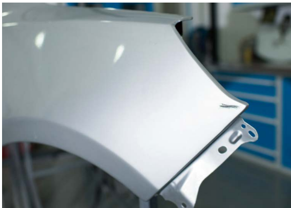
图5 翼子板的损伤区域
