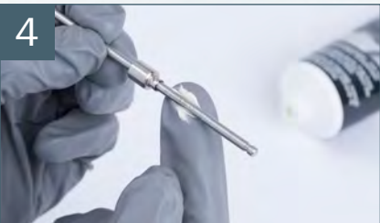
在枪针接触密封圈的位置周围涂抹专用润滑油*
