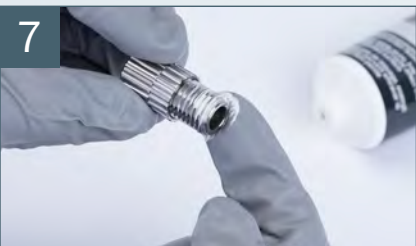
在涂料调节旋钮的螺纹上涂抹专用润滑油*
