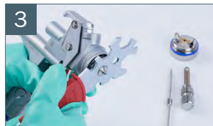
使用工具包里的原装扳手取下喷嘴
