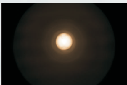
A 厂商的高品质手电筒示例 光照范围非常小，光强度不均匀，颜色明显泛黄。
