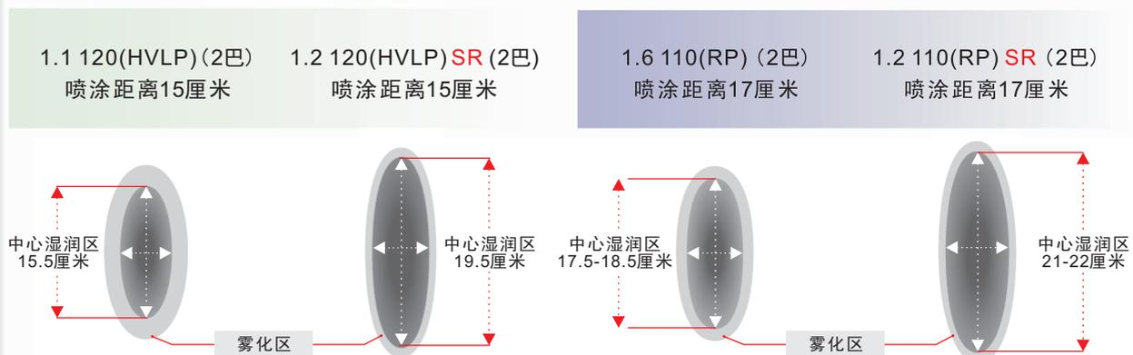
标准喷嘴的喷幅中心区更湿润，更紧凑。SR喷嘴套装的喷幅中心比较薄而且宽。
