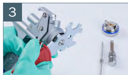
3 使用工具包里的原装扳手取下喷嘴
