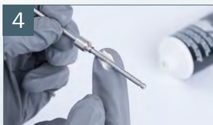
4 在枪针接触密封圈的位置周围涂抹专用润滑油*
