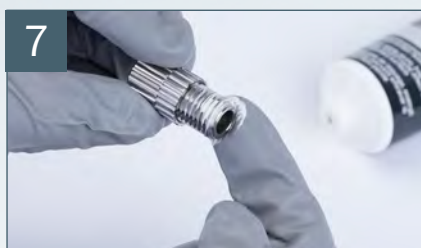
7 在涂料调节旋钮的螺纹上涂抹专用润滑油*
